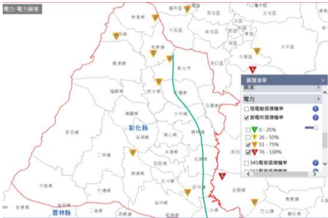
圖1-3-9模擬變電所損壞機率
