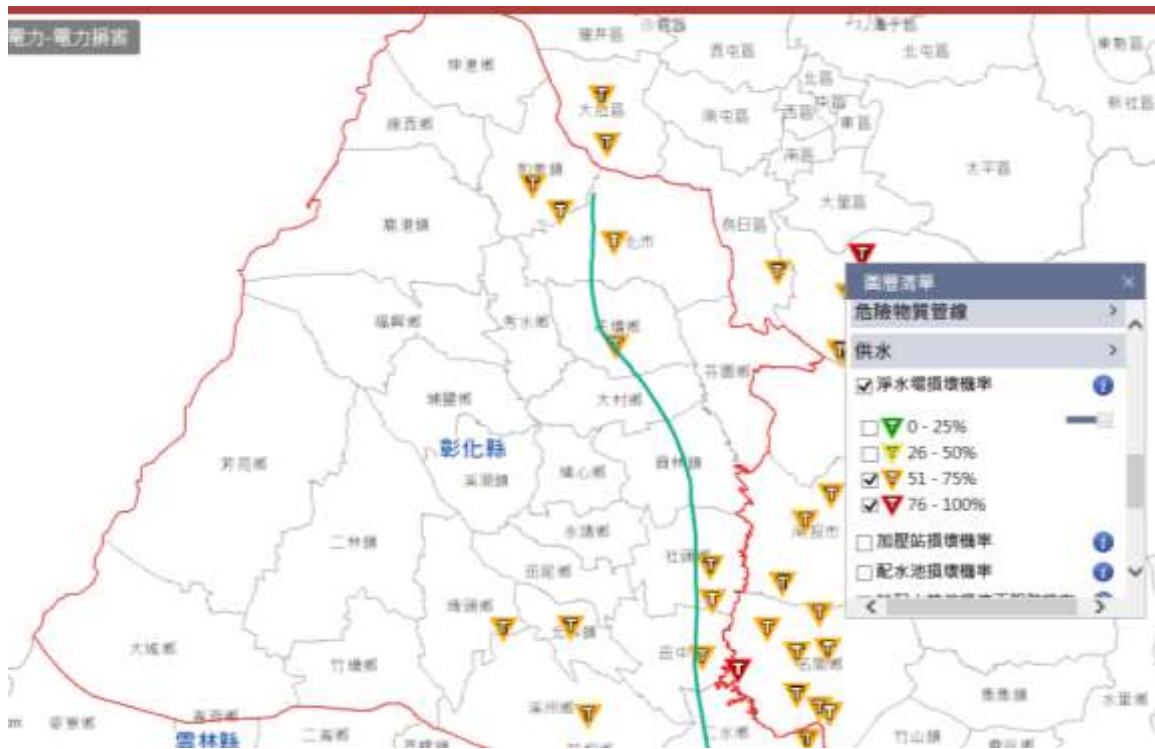
圖1-3-10模擬淨水廠損壞機率
