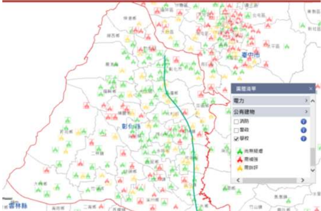
圖1-3-8重要公有建築物以「學校體系」資訊顯示 (3)模擬變電所損壞機率，以彰化縣來看，機率超過50%的變電所損壞約有7處，分別坐落於伸港鄉、線西鄉、和美鎮、彰化市、秀水鄉、埤頭鄉、田中鎮。
